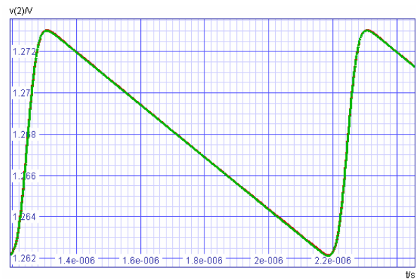
Slika 6: Odziv testnega vezja, dobljen z ravnotežno harmonsko analizo in s tranzientno analizo (razlika je neopazna).
