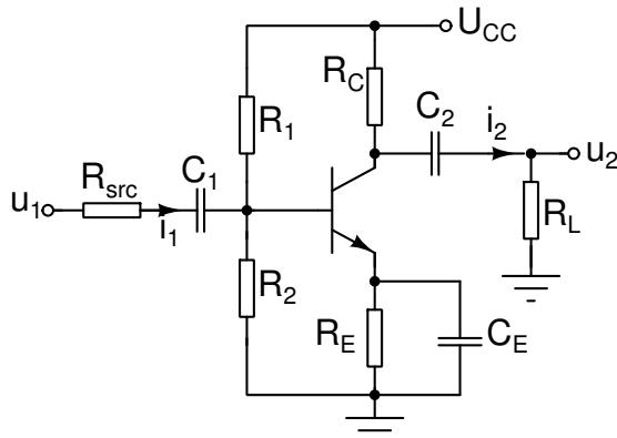
**Naloga 4**Določite  $R_E, R_C$ , da bo v delovni točki  $I_C = 1mA, U_{CE} = 6V$ .
