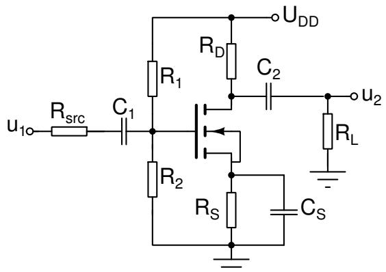
**Naloga 2**Delovni tok tranzistorja je  $I_D = 1.39mA$ . Določite tokovno ojačenje  $A_i = \frac{i_2}{i_1}$  pri srednjih frekvencah.
